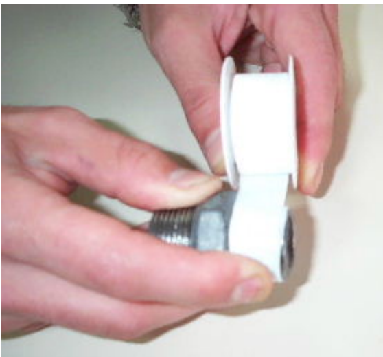
Metodo de aplicacion de cintas de PTFE Teflon
